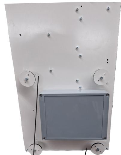
**Auf der Rückseite des Aufzug sind 4 Teile angebracht, um den Aufzug in ein DIN A4 Format zu integrieren, Rahmen wie in Electro Labore**
